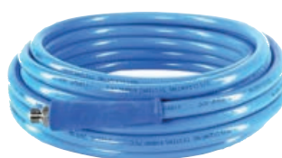
TUYAUMPSOG Serti M/M_1/2 inox et qualité alimentaire. 70°C / 40 bars. 2 à 100m
